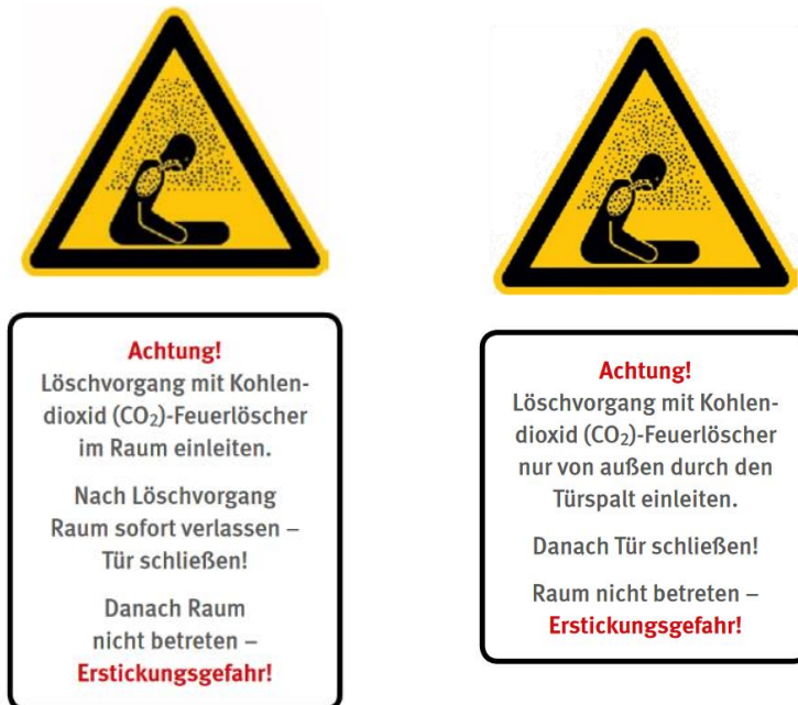
Abbildung 1: Löschen mit CO 2 -Löscher im Raum (DGUV-I 205-034)
